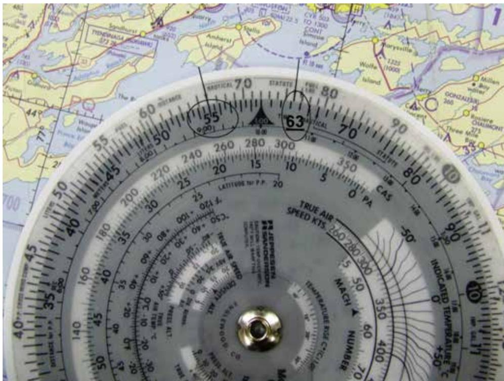
Figure A-4 Calculateur de vol
